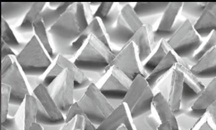
**Präzisionsgeformtes, dreieckiges Keramiksleifkorn**
